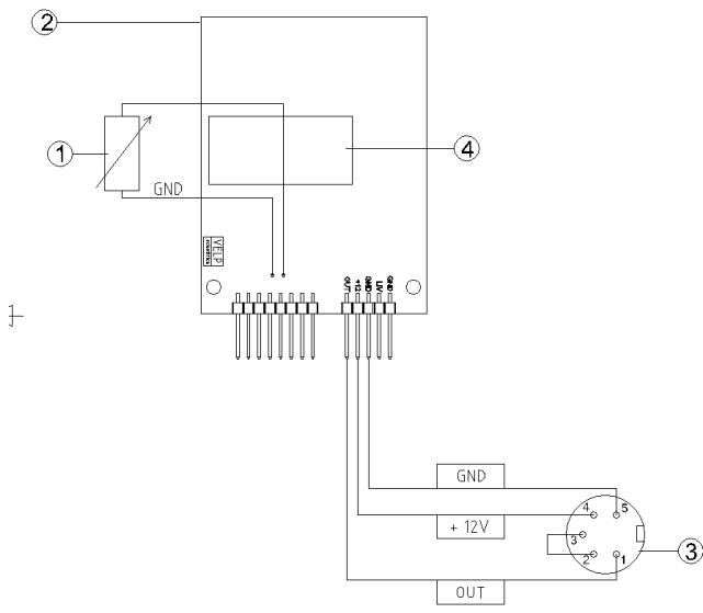
1. Pt100 Probe / Sonda Pt100 / Sonde Pt100 / Sonda Pt100 / Pt100-Fühler
